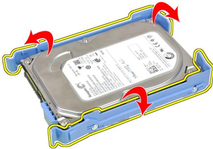
5. Extraiga los tornillos que fijan la minitarjeta de unidad de disco duro al soporte de la unidad de disco duro y extraiga la unidad de disco duro de su soporte.
