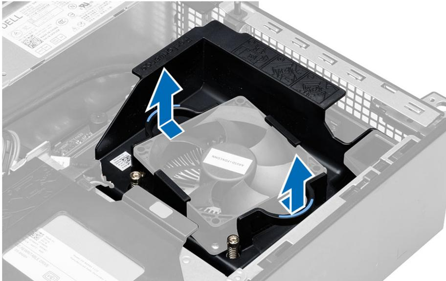
4. Desconecte el cable del ventilador de la placa base. Suelte los tornillos cautivos que fijan el ensamblaje del disipador de calor al equipo y retírelo del equipo.
